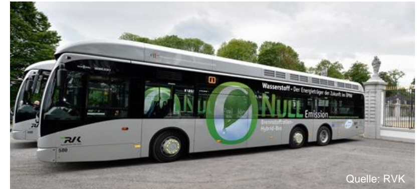
Beispiel: Van Hool A330 Fuel Cell - Eingesetzt vom RVK in Köln - Betankung am Chemiepark
